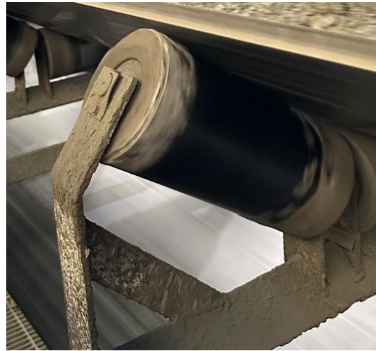
Bild 10: Tragrollenzustand im Mai 2023 nach 4,5 Jahre im Dauerbetrieb
