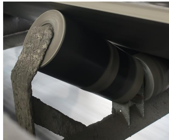
Bild 8: Selbstreinigende Manteloberfläche der xForce-Tragrolle
