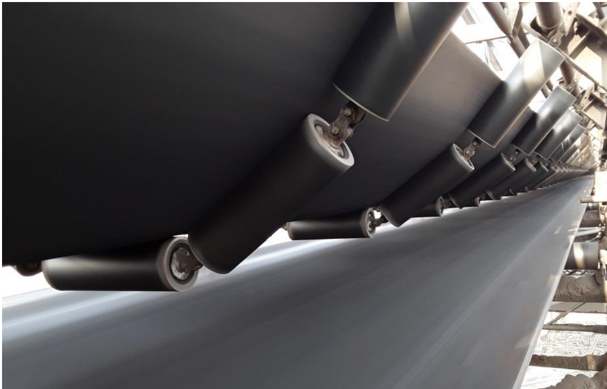
Bild 6: Fünfteilige Girlandenausführung mit xForce Composite Tragrollen (Massenstrom 22.000 t/h, Bandgeschwindigkeit bis 10 m/s)
